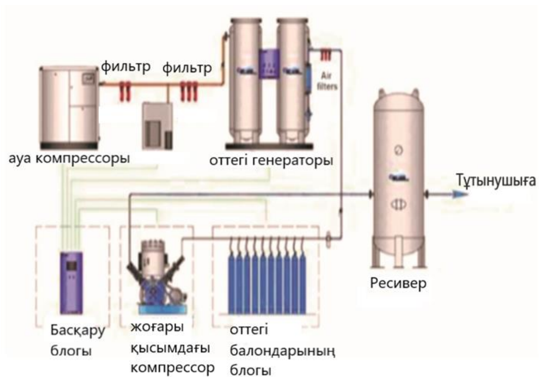
1.3 Сурет – Оттегі станциясының құрамдас бөлшектері
