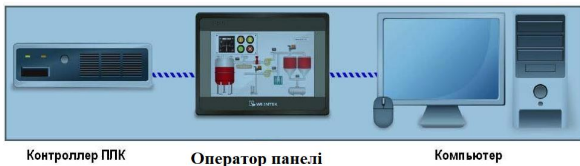
2 Сурет – Touch-screen мен контроллер байланысы
