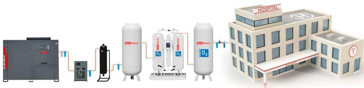
1.1 Сурет – Стандартты оттегі станциясының жұмыс істеу принципі
