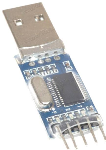
3.9 Сурет – Конвертер USB–UART (COM RS232)
