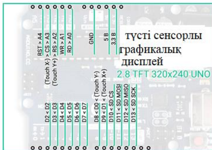
2.4 Сурет – Сенсорлы экран платасы
